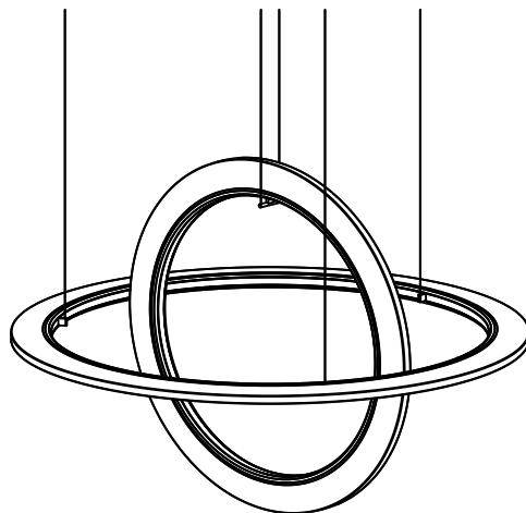
6. Montar colgantes horizontales inclinadas, hasta 45 grados (los puntos de fijación indicados en la plantilla suministrada no serán válidos).
